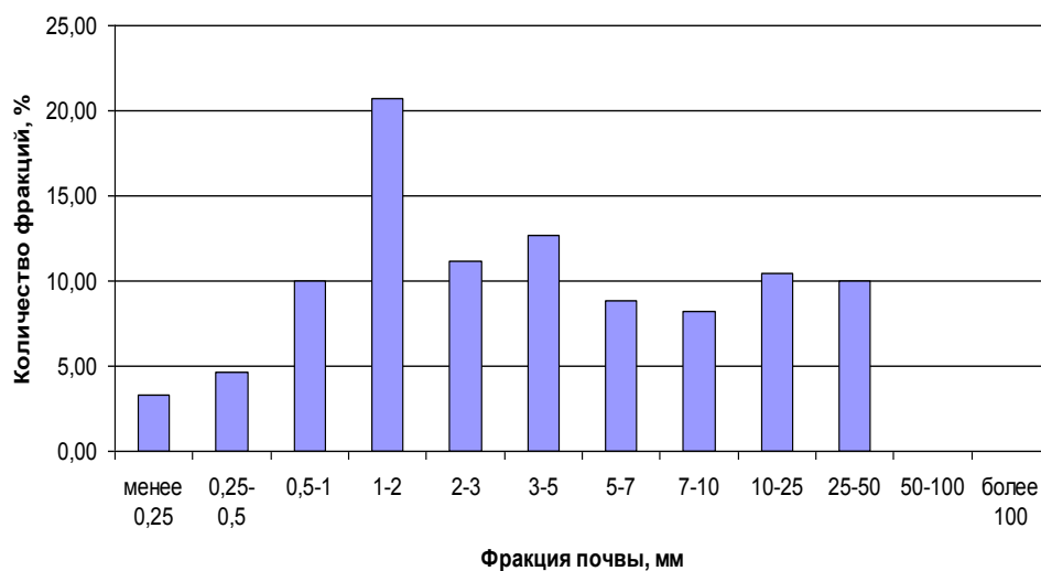
Рисунок 6 – Процентное содержание фракций почвы при v_{\text{окр}}=3,9 м/с, n=4 , \gamma=10^\circ
